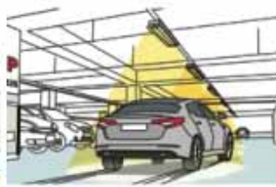
Schritt 2: Bewegungsmelder reagiert auf Autos und Personen. Der zentrale Controller schaltet die raumspezifische LED-Beleuchtung ein und wieder aus.
